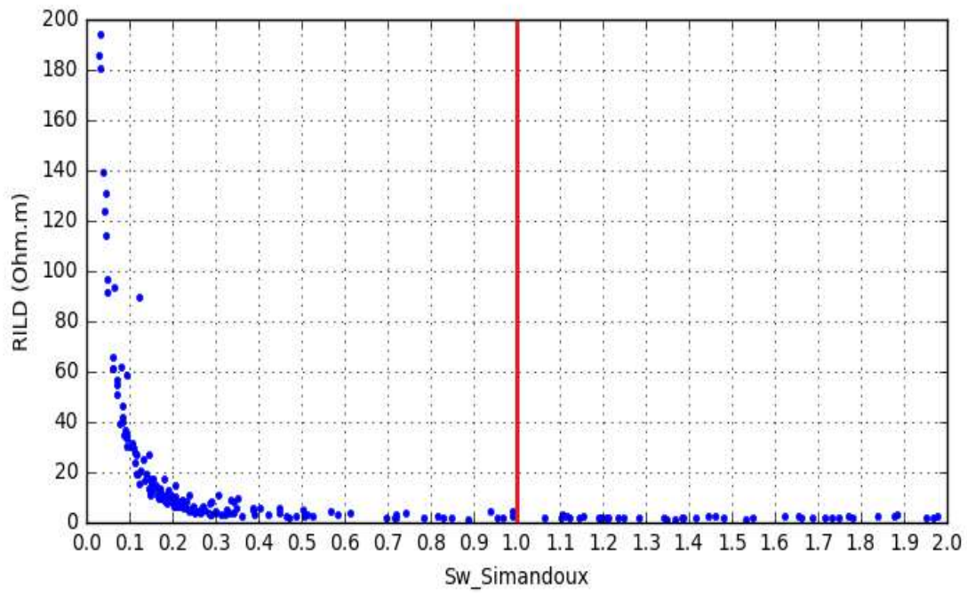
Figura 4.26: Resposta da equação de Simandoux em relação a resistividade da rocha (RILD) do poço 3-NA-04. Pontos acima de 1.0 (100%) de saturação representam valores extrapolados de S_w .
