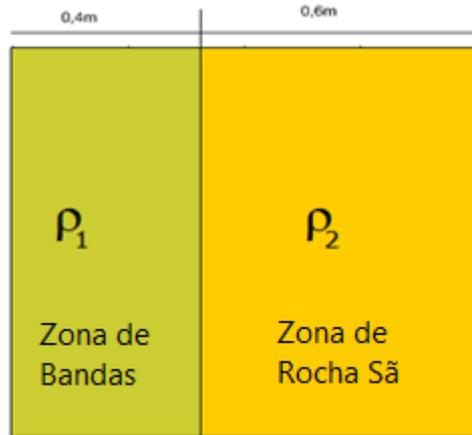
Figura 2.4: Representação da zona central com 200 bandas de deformação por metro, sendo que cada banda possui 2 mm de largura, totalizando em 0,4 m de rocha deformada com 5% de porosidade. (Fonte: Souza, 2013)
