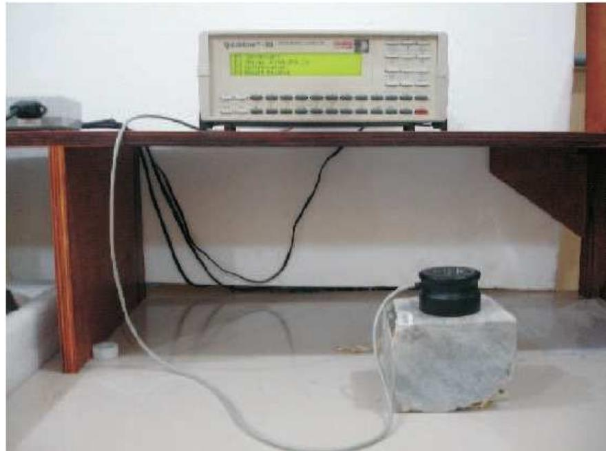
Figura 2.1: Analisador *Quickline<sup>TM</sup>-30* da Anter Corporation utilizado na medição das propriedades térmicas de rochas. As medidas são feitas em duas faces planas polidas e perpendiculares entre si.
