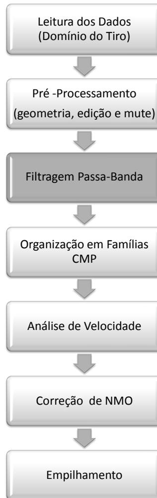
Figura 3.4: Fluxograma de processamento utilizado na aplicação da filtragem passa-banda
