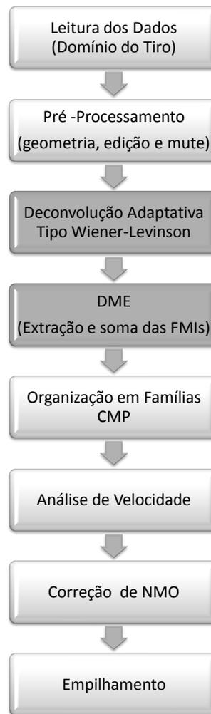
Figura 3.22: Fluxograma que descreve as etapas de processamento na aplicação conjunta dos métodos DME e DTWL no domínio do tempo.
