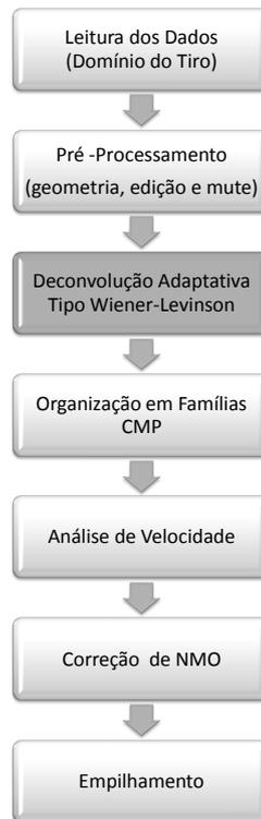
Figura 3.10: Fluxograma que descreve as etapas de processamento na aplicação do método de deconvolução de Wiener-Levinson.
