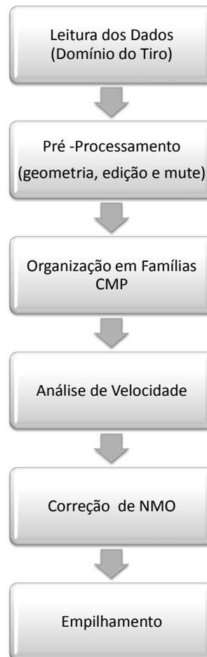
Figura 3.1: Fluxograma que descreve as etapas de processamento envolvidas na construção da seção empilhada bruta.
