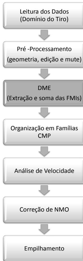
Figura 3.15: Fluxograma que descreve as etapas de processamento na aplicação do método DME no domínio do tempo.
