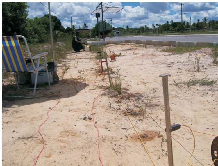
Figura 3.1: Arranjo Schlumberger utilizado em campo.
