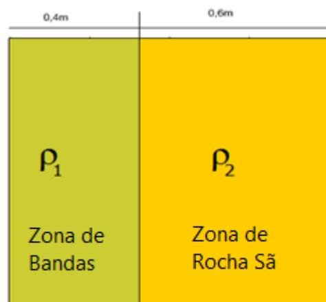
Figure 2.3: Representação da zona central com 200 bandas de deformação por metro, sendo que cada banda possui 2 mm de largura totalizando em 0,4m de rocha deformada com 5% de porosidade.
