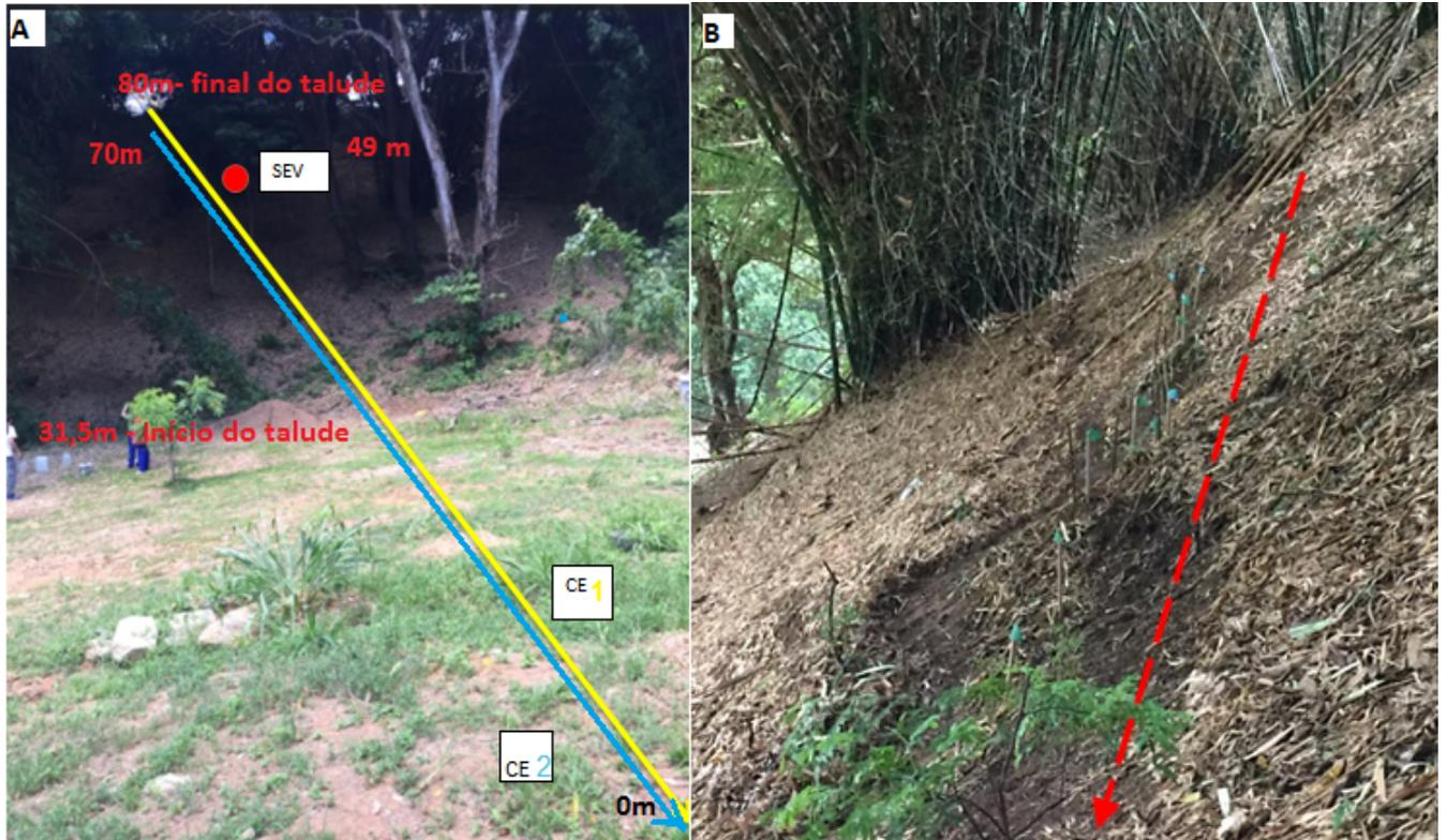
Figura 4.1: (a) Localização da SEV e do CE no local (b) disposição dos eletrodos da SEV.
