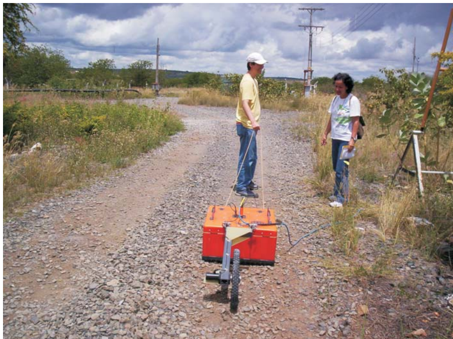
Figura 1.3: Equipamento SIR-2000 da GSSI em operação no campo. As antenas (transmissora e receptora) estão dentro da caixa laranja, a roda, vista na figura, é o odômetro do sistema, a CPU não pode ser vista na figura.
