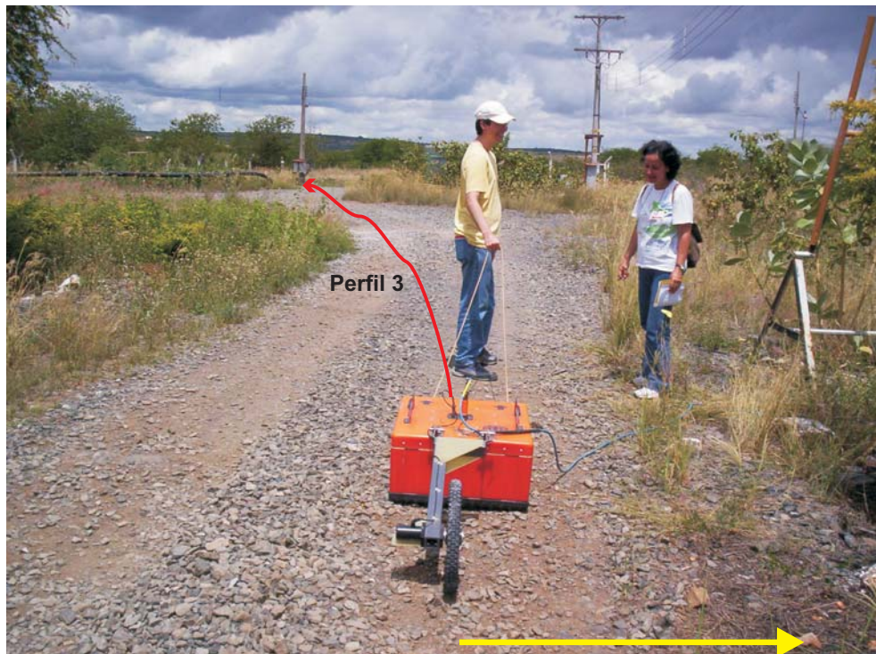
Figura 3.8: Imagem ilustrando a trajetória de levantamento deste perfil, bem como, a referência de seu início (seta amarela). Pode-se ver também o equipamento empregado no presente trabalho, neste caso, um SIR SYSTEM 2000 fabricado pela GSSI com antena de frequência central de 200 MHz (o CPU que armazena os dados não pôde ser visto na imagem).
