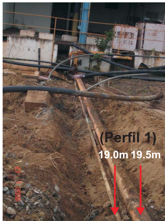
Figura 3.5: Imagem mostrando duas tubulações desenterradas que correspondem as anomalias à 19.0m e 19.5m de distância do início do perfil 1.
