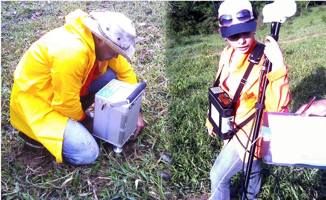
Figura 4.4: À direita o CG-5 da Scintrex Geophysics e à esquerda o GSM-19G *Overhouse* da Gem Systems.
