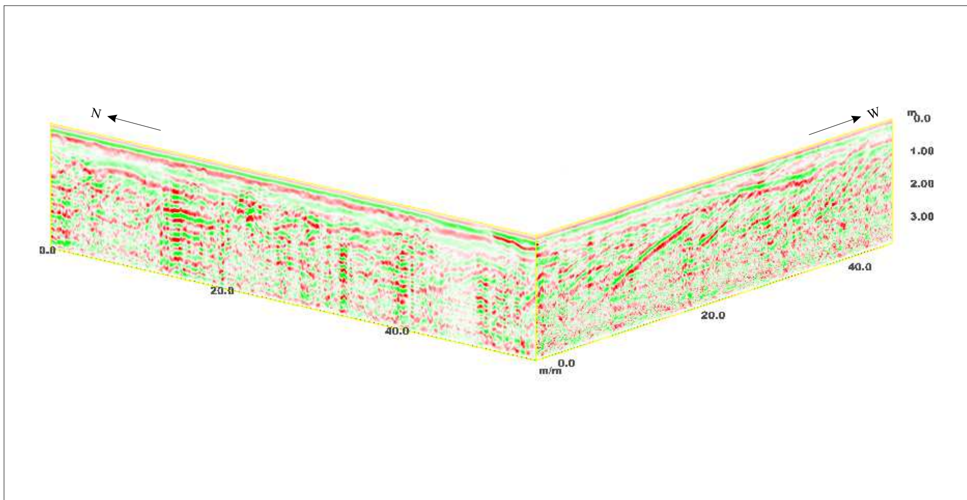
Figura 4.7: Visualização 3D da subsuperfície do afloramento do Membro Boipeba, representada pelos radargramas boipeba01 e boipeba02.
