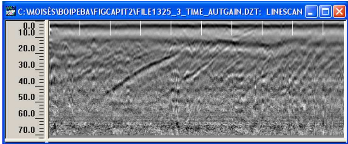
Figura 2.5: Radargrama boipeba02 após a aplicação de ganhos automáticos de fator 20 numa janela de 20 ns, onde o intervalo entre cada marcador representa 5m e a escala vertical representa o tempo duplo de trânsito em ns.
