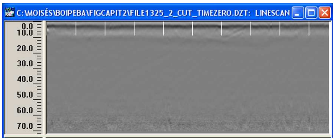
Figura 2.4: Radargrama boipeba02 após um mute para tempos maiores que 70 ns e correção do tempo zero, onde o intervalo entre cada marcador representa 5m e a escala vertical representa o tempo duplo de trânsito em ns.
