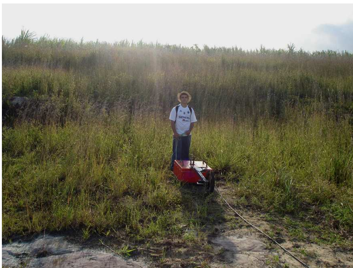
Figura 1.3: Antenas em modo monoestático com frequência da fonte igual a 200\text{ MHz} .
