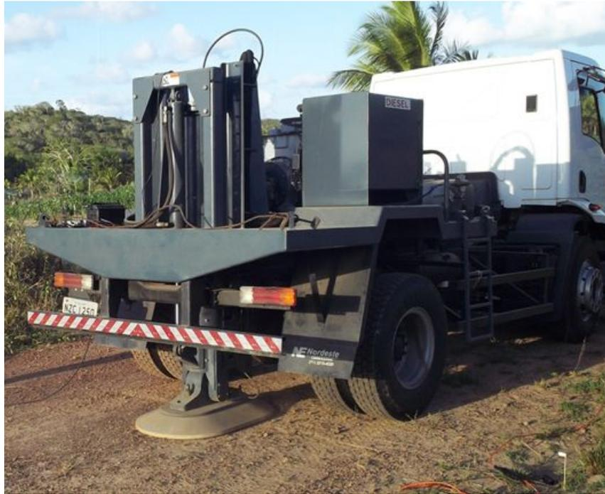
Figura 3.2: Acoplamento da placa de aço ao solo.
