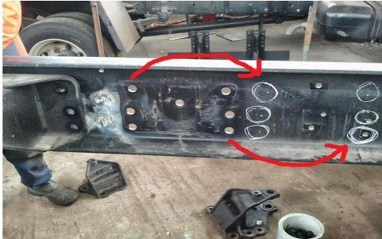
Figura 2.11: Posicionamento dos novos furos do eixo traseiro.
