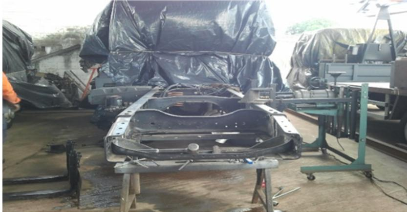
Figura 2.9: Caminhão desmontado.
