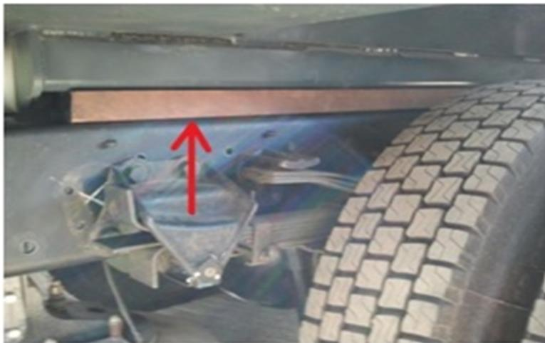
Figura 2.14: Madeiras colocadas entre as longarinas do chassi e a fonte sísmica AWD.
