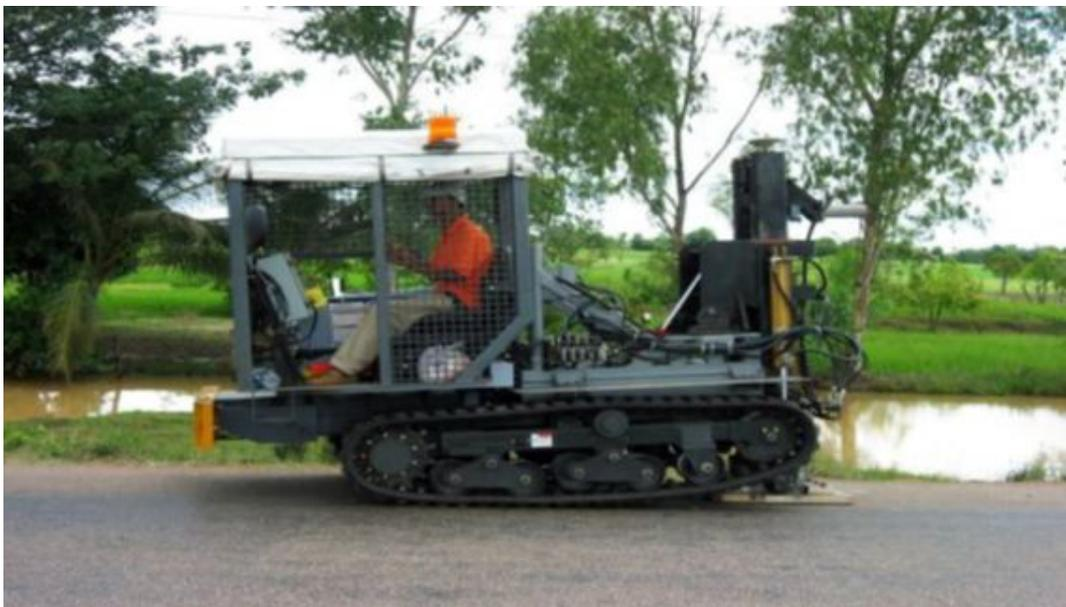
Figura 3.6: Fonte sísmica AWD montada num trator.
