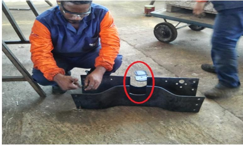
Figura 2.15: Travessa adaptada (observar os cortes no centro).
