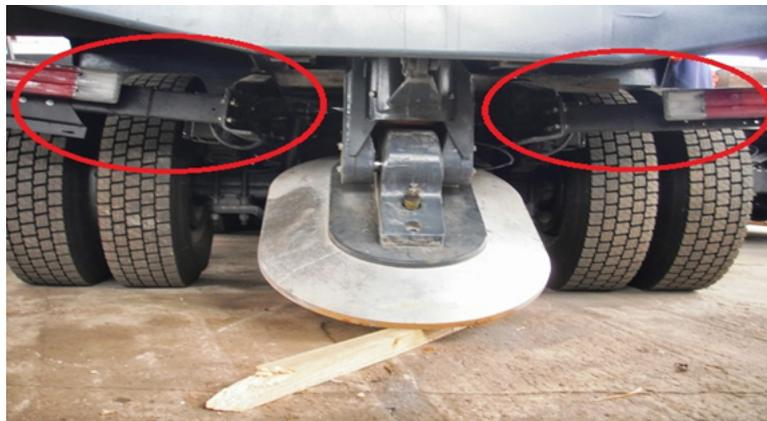
Figura 2.7: Envergamento do chassi (observar as lanternas).
