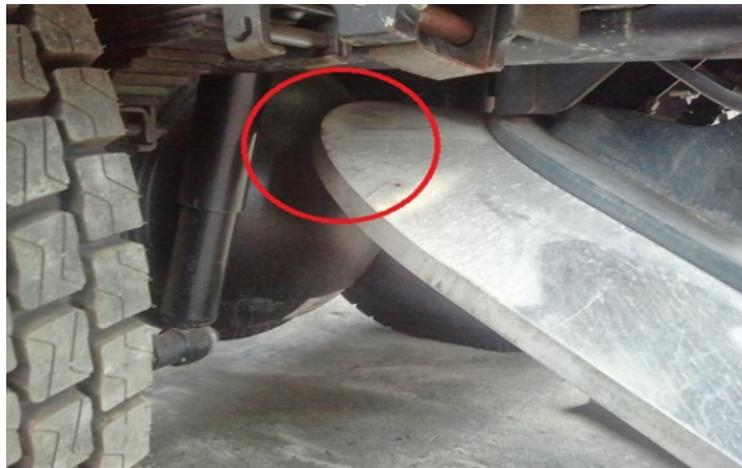
Figura 2.5: Contato entre o 'martelo' e a caixa do diferencial.
