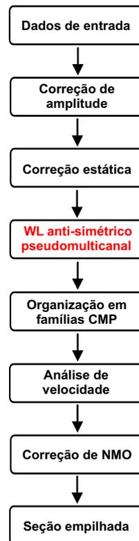
Figura 3.9: Fluxograma de processamento empregado para obter a seção sísmica empilhada da Figura 3.8.
