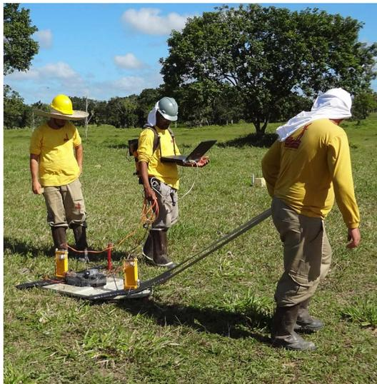
Figura 2.2: Foto do sistema RAMAC sendo deslocado sobre o terreno usando uma separação de 60 centímetros entre as antenas de 200 MHz).
