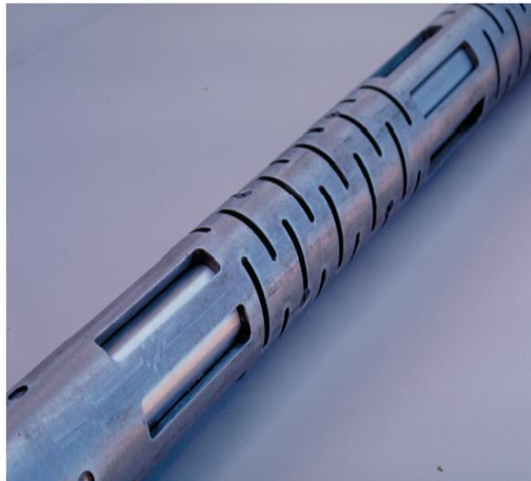
Figura 2.13: Ilustrações de ferramenta sônica, em detalhe os intervalos rajados que tem por objetivo atenuar o acoplamento direto da fonte com o receptor.
