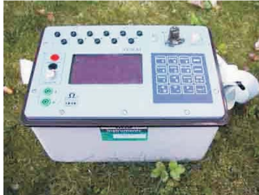
Figura 4.1: Modelo do equipamento SYSCAL-PRO utilizado nos levantamentos em campo
