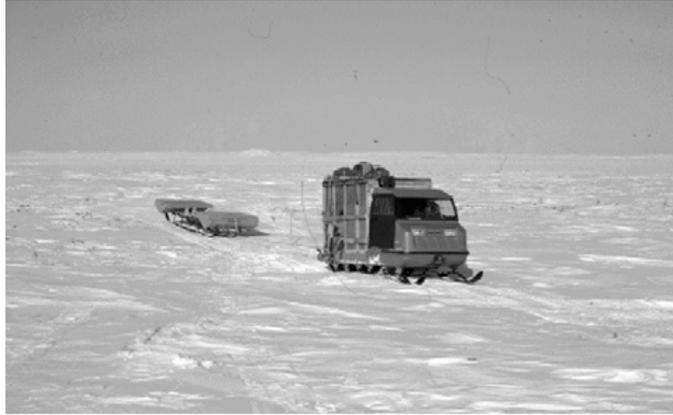
Figura 1.3: Sistema de GPR sendo utilizado para sondar potenciais rotas de tubulações no Ártico canadense (Annan, 2003).
