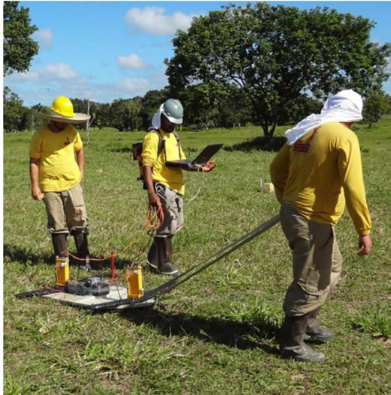
Figura 3.3: Foto do sistema Ramac sendo puxado sobre o terreno usando uma separação de 60 cm entre as antenas de 200 MHz.
