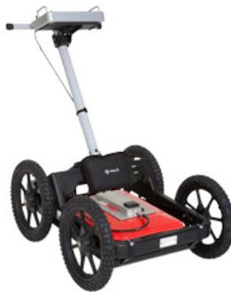
Figura 3.4: Foto do novo sistema Easy Locator HDR (High Dynamic Range) da Mala Geoscience.
