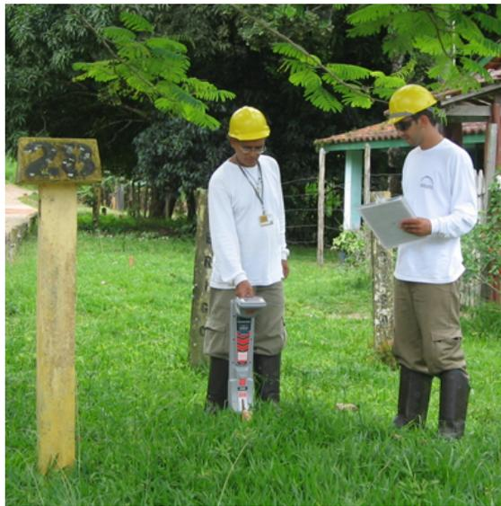
Figura 3.55: Exemplo ilustrativo do modo de localização com PCM (pipe locator).
