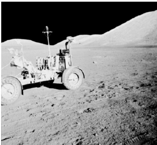
Figura 1.2: Experimento realizado durante a missão Apollo 17 sobre propriedades elétricas da subsuperfície lunar. Utilizou-se um receptor com 3 componentes vetoriais e uma antena dipolar multi-frequência com dois eixos (Annan, 2003).
