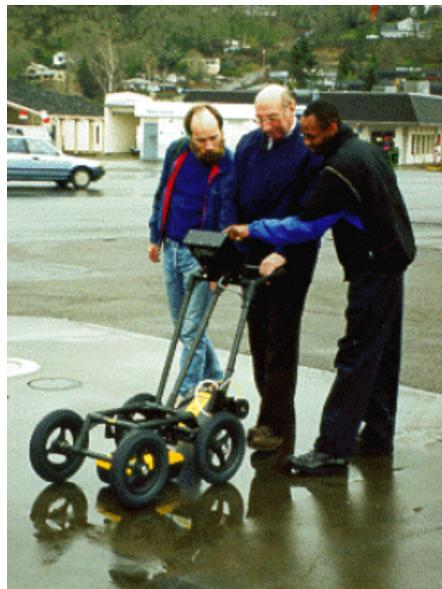
Figura 1.4: Carrinho de GPR desenvolvido por Noggin da Sensors & Software Inc. (Annan, 2003).
